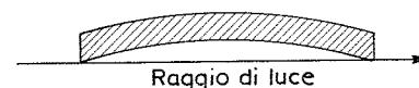
Fig. 140. Verifica della forma rettilinea di un bordo con l'aiuto di un raggio di luce.
